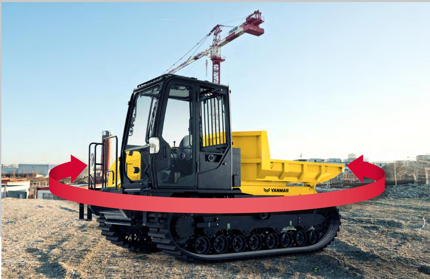
La masa total del C50R-5A se distribuye uniformemente en la base mediante 32 rodillos. Completamente cargada, la máquina tiene una presión sobre el suelo de tan solo 32,4 kPa. Esto mejora considerablemente las prestaciones todo terreno, lo que permite que el C50R-5A pueda trabajar en terrenos que se encuentran en las peores condiciones.
