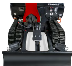
Tren de rodaje retraído : 980 mm
