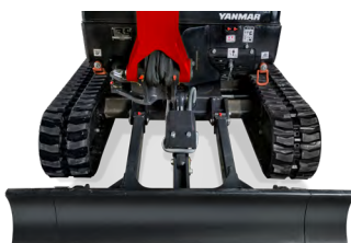
Tren de rodaje extendido : 1 170 mm
