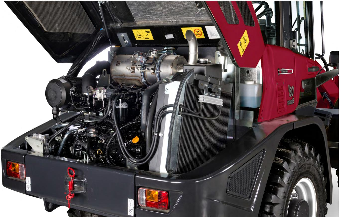
La gran apertura que presenta el capó del motor permite acceder fácilmente a los elementos principales del funcionamiento de la máquina para realizar labores de mantenimiento fáciles y rápidas. Esto contribuye a reducir el CTP de la máquina. Las tareas de mantenimiento diarias pueden llevarse a cabo desde el suelo para ahorrar tiempo.
