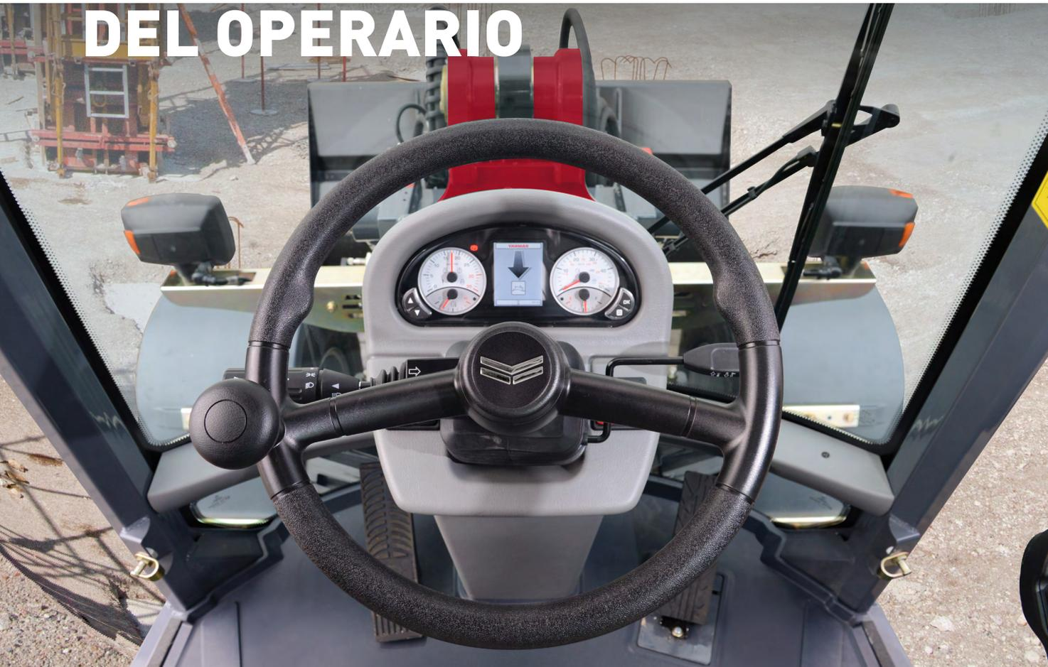
La cabina, que se ha diseñado teniendo en cuenta la productividad y la comodidad del operario, cuenta con un amortiguador de ruido y vibraciones, y cumple la certificación ROPS/FOPS.
