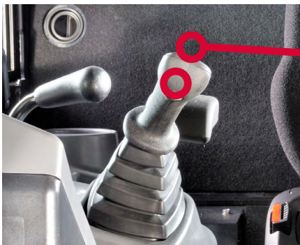
1 Potenciômetro do botão de suspensão da operação de tomada de potência (PTO)
