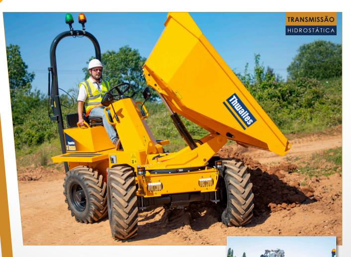
O Dumper basculante de 3 toneladas, Fase V, da Thwaites, é fabricado a pensar nos empreiteiros, proporcionando maior segurança para o operador, reduzindo o risco no local e melhorando o desempenho. Alimentada por um motor Yanmar de 18,1 kW e 3 cilindros, com um binário máximo de 107 Nm para uma tração e controlo ideais, esta máquina é acionada por uma transmissão hidrostática, tornando-a simples e fácil de operar.
