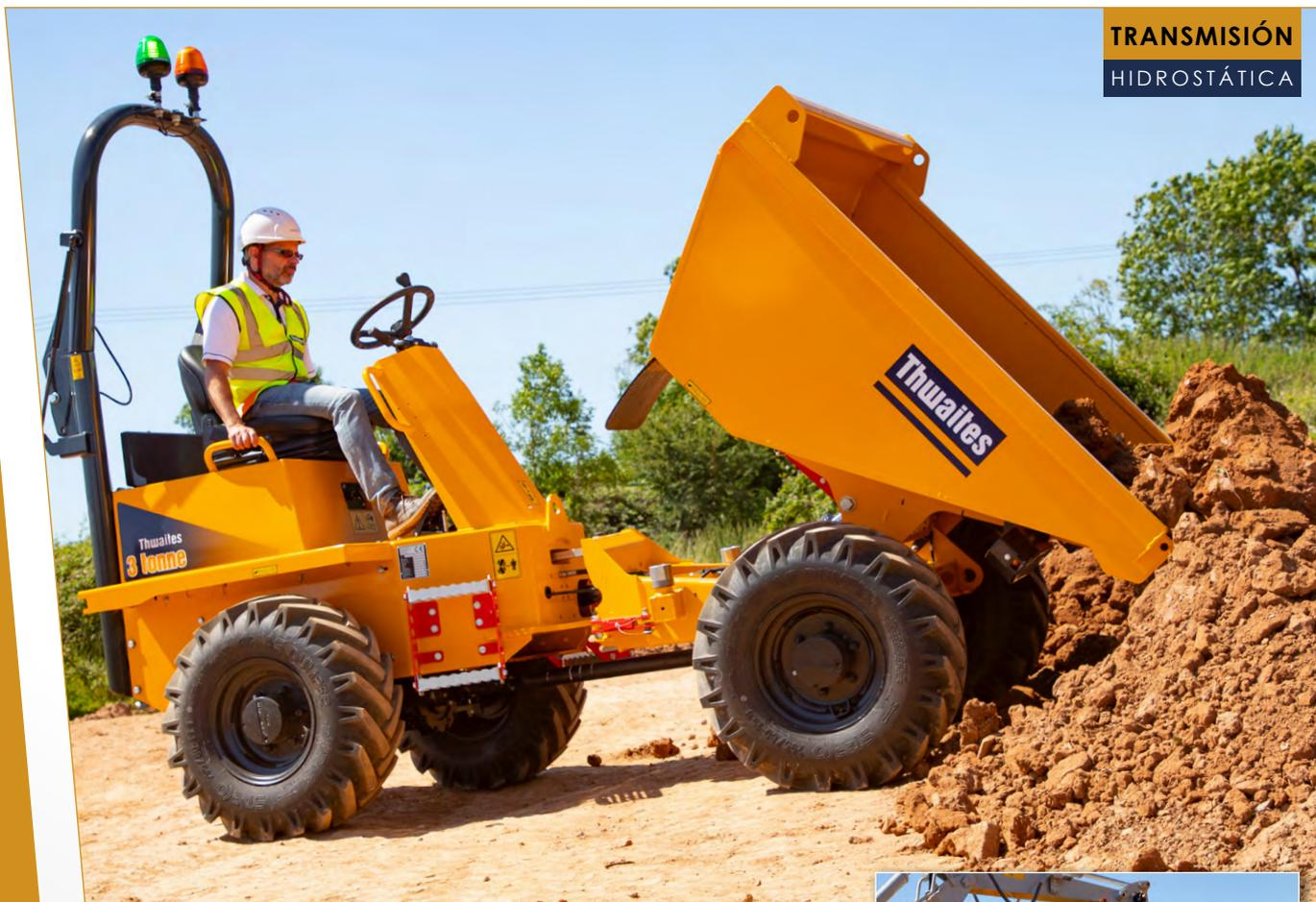
El dumper de fase V con volcado hacia adelante de 3 toneladas de Thwaites se ha fabricado pensando en los contratistas y arrendatarios, para garantizar la seguridad del operario, reducir el riesgo en la zona de trabajo y mejorar el rendimiento. Con un motor Yanmar de 18,1 kW y 3 cilindros, que proporciona 107 Nm de par máximo para desarrollar una tracción y un control óptimos, esta máquina cuenta con una transmisión hidrostática que ofrece un manejo sencillo y directo.
