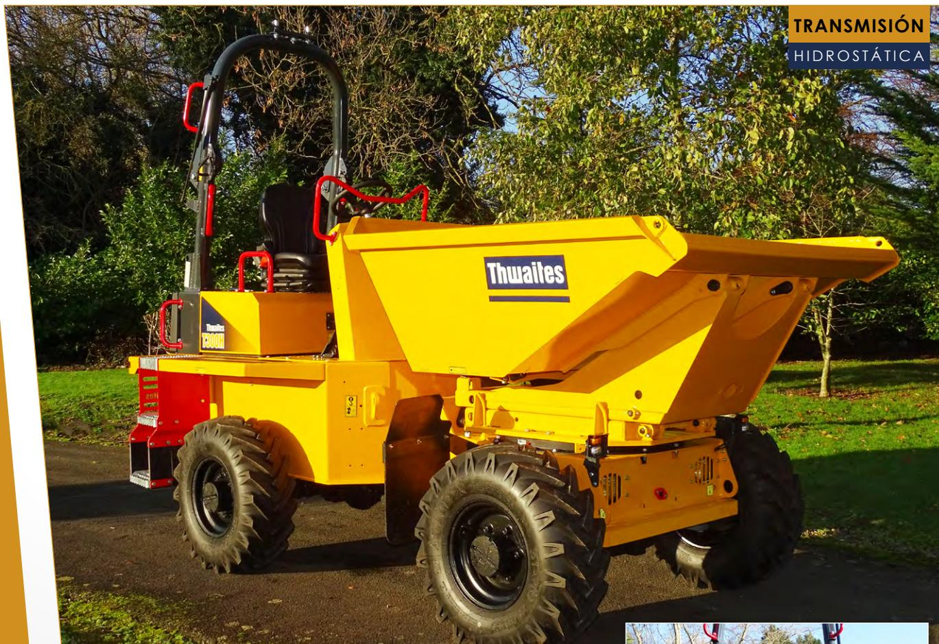
El dumper T300H de fase V con tolva giratoria con descarga en altura de Thwaites se ha fabricado pensando en los contratistas y arrendatarios, para garantizar la seguridad del operario, reducir el riesgo en la zona de trabajo y mejorar el rendimiento. Con un motor Yanmar de 33,3 kW, que proporciona 142 Nm de par máximo para desarrollar una tracción y un control óptimos, esta máquina cuenta con una transmisión hidrostática que ofrece un manejo sencillo y directo.
