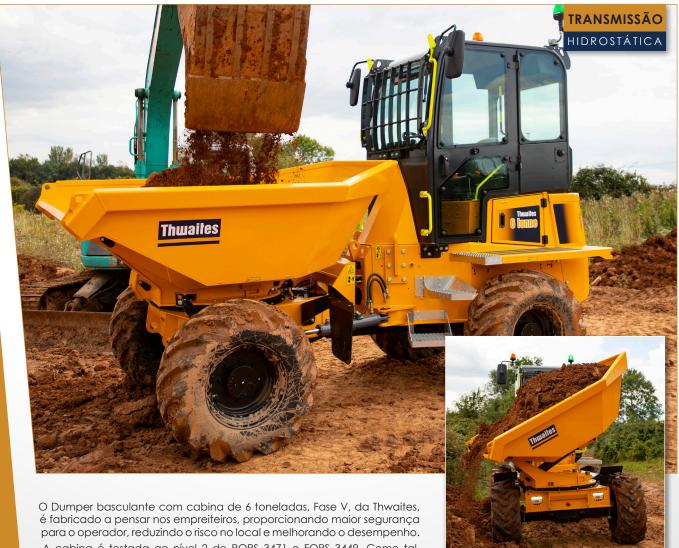
A cabina é testada ao nível 2 de ROPS 3471 e FOPS 3449. Como tal, todos os dumpers Thwaites com cabina são aprovados pelo UK Major Contractors Group. O balde Powerswivel permite uma rotação de 90° para a esquerda e para a direita, facilitando o acesso a cargas basculantes em áreas restritas e dando maior controlo ao operador, reduzindo assim o risco no local.
