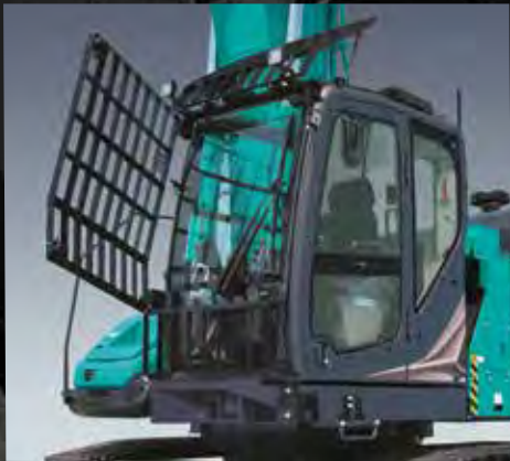
Protección de cabina con apertura/cierre fácil de limpiar (ventana delantera superior y claraboya)
