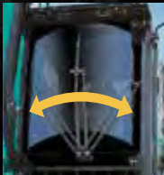
Zona de barrido del limpiaparabrisas delantero un 36 % mayor (en comparación con la cabina estándar)
