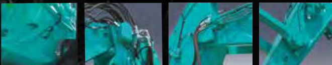
Sensor del ángulo del balancín Sensor del ángulo del aguilón Sensor del ángulo del brazo Sensor del ángulo del cazo
