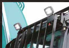
Frontal del techo de la cabina (dos lámparas)
