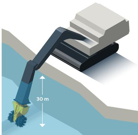
Podem ser utilizadas até 30 metros abaixo de água sem instalação ou modificação adicional
